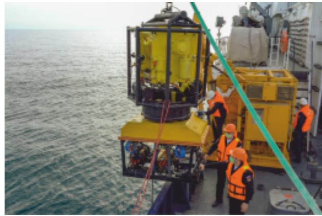
Спуск телевизионного необитаемого подводного аппарата.
